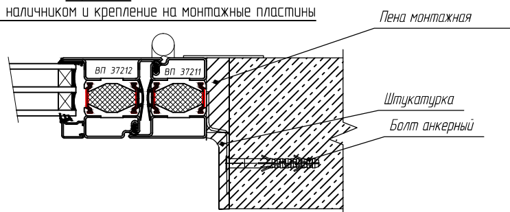
Вариант 4 Установка конструкции в четверть с доборным профилем
